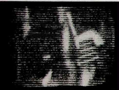
Abb. 1. Streifenstörungen durch Gleichkanalbetrieb der FS-Sender Hamburg und Langenberg (Kanal 6). Aufnahme im Augenblick, als der abgestimmte Sender Hamburg im Feldstärkeminimum und der aus Richtung 90 Grad einfallende Sender Langenberg im Feldstärkemaximum war
