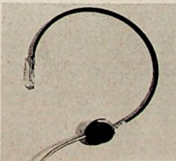
Ansicht des Peiker-Kristall-Kehlkopfmikrofones mit Bügel und abgeschirmter Anschlußleitung
