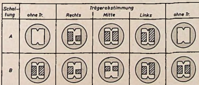
Abb. 21. Schaltungen mit der 6 AL 7 zur Abstimmzeige im FM-Empfänger; A für Hellsteuerung, B für Anzeige auch ohne Sendersignal
